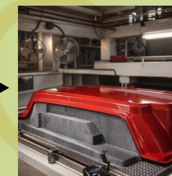
③ 真空・FRP成形
