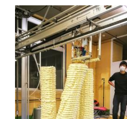
3Dプリンティングで型を造形
